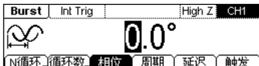
图 11 脉冲串波形设置界面
