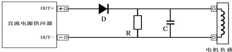
我公司系列直流电源供应器能够满足用户阻性、容性、感性等不同性质负载的正常使用要求。但是，由于阻性、容性、感性等负载的性质差异，在具体应用时，仍然要针对不同负载的性质采取相应的措施，以便获得最佳的使用效果！
