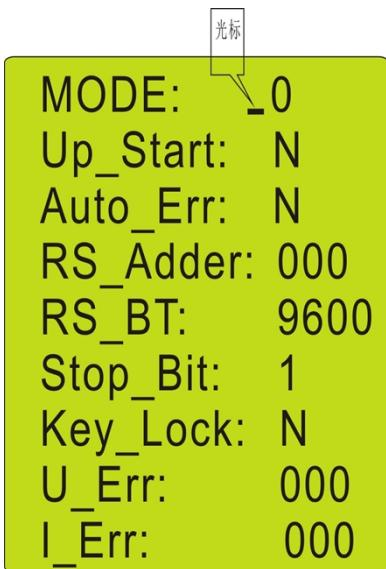
按下“飞梭”键，进入电源系统菜单设置，按“U/I”键可以移动光标循环选择上面其中的一项进行设置，再次按下“飞梭”键，电源退出系统菜单并保存当前的设置后返回主界面。
