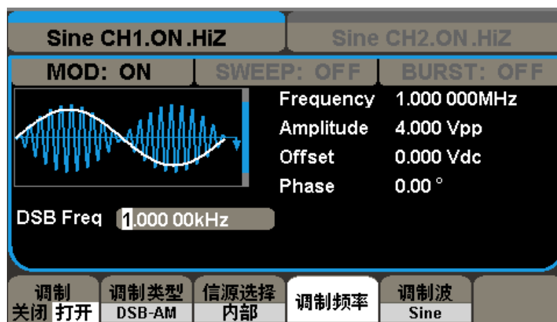
图3-9 输出DSB-AM 调制波
